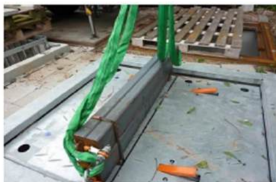
Tests de conformité à la norme EN 13071-1 & 2. Poids testés: 156kg et 346kg
