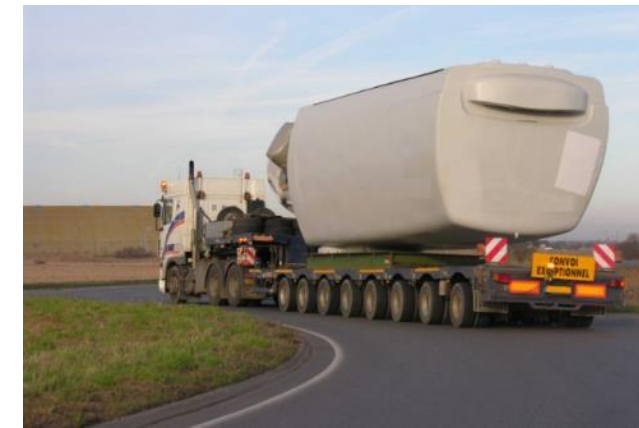
Photo 50 : transport de la nacelle
